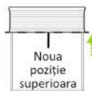
Apăsați simultan butonul **SUS + STOP** și mențineți apăsat timp de (5 secunde) (motorul se va mișca x1 și va emite un semnal sonor lung x1) → utilizați butoanele **SUS/JOS** pentru a seta noua poziție finală superioară, → apăsați butoanele **STOP + SUS** simultan (2 sec) (motorul se va mișca x2 și va emite un semnal sonor x3).
