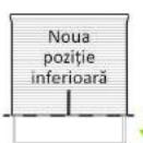
Apăsați simultan butonul **JOS + STOP** și țineți apăsat timp de (5 sec) (motorul se va mișca x1 și emite un bip lung x1) → utilizați butoanele **SUS/JOS** pentru a seta o nouă poziție finală inferioară, → apăsați simultan butoanele **STOP + JOS** (2 sec) (motorul va funcționa mișcare x2 și emite un semnal sonor x3).
